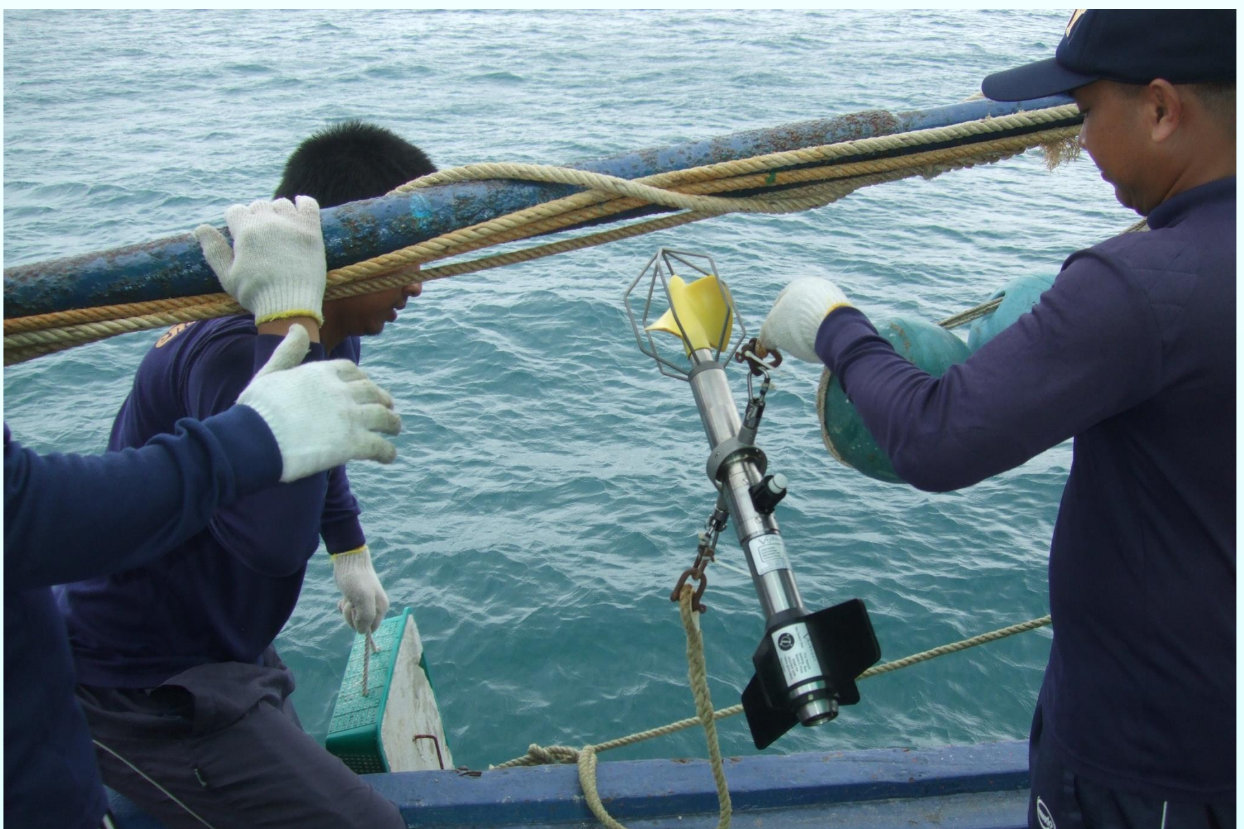
รูปที่ ๔ เครื่องมือวัดความเร็วและทิศทางกระแสน้ำทะเลแบบต่อเนื่อง
