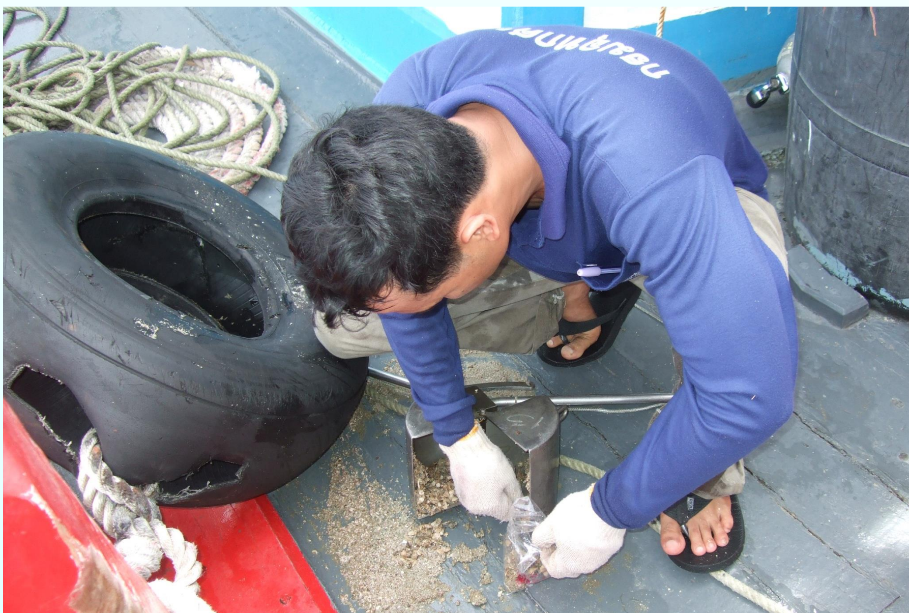
รูปที่ ๓ เครื่องมือการเก็บตัวอย่างตะกอนพื้นท้องทะเล
